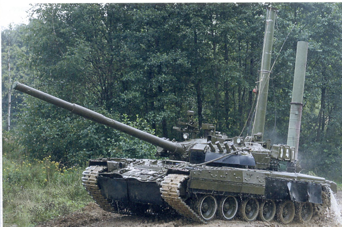
Вот так используются те самые трубы, что обычно перевозятся на «спине» башни. Это танк Т-80
