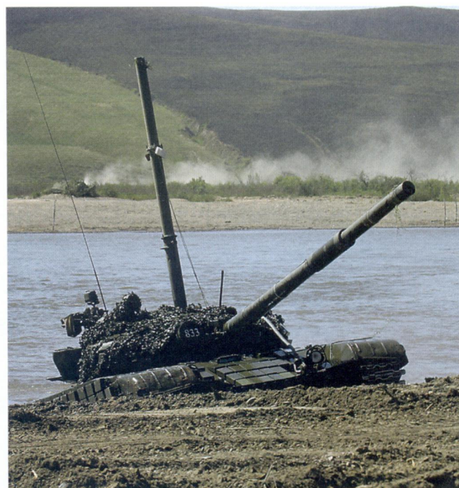
Если на танке стоит одна тонкая труба, то это значит, что водную преграду форсирует или Т-72 или Т-90
